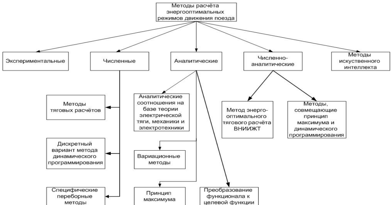
Рис. 1 – Классификация методов расчёта энергооптимальных режимов движения поезда
