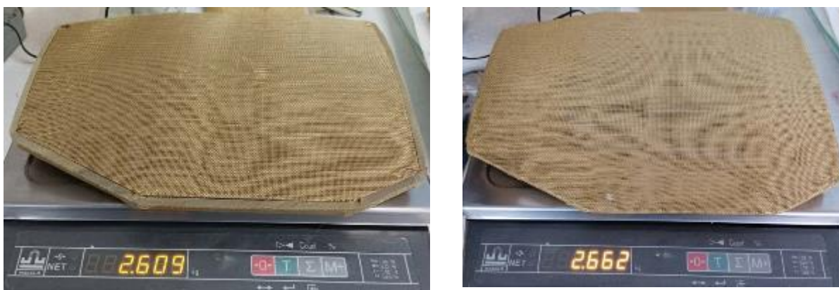
Рис. 5. - Приклеивание керамики к подложке. Оборачивание панели в арамидную «рубашку».
