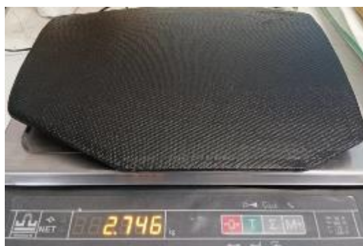
Рис. 5. - Приклеивание керамики к подложке. Оборачивание панели в арамидную «рубашку».
