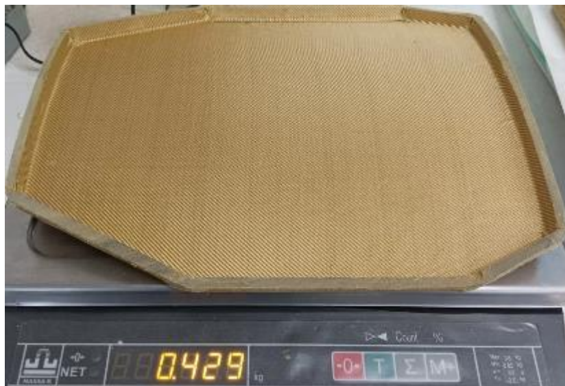
Рис. 3. - Арамидная подложка радиусной формы с загнутыми краями, изготовленная при помощи вакуумного прессования
