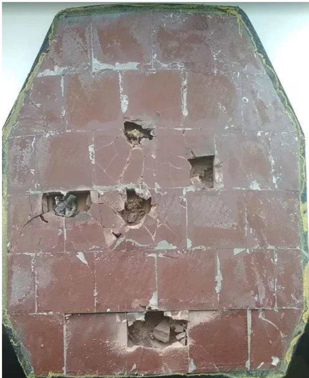
Рис.8. – Разрушение керамического слоя бронепанели Бр4 класса защиты
