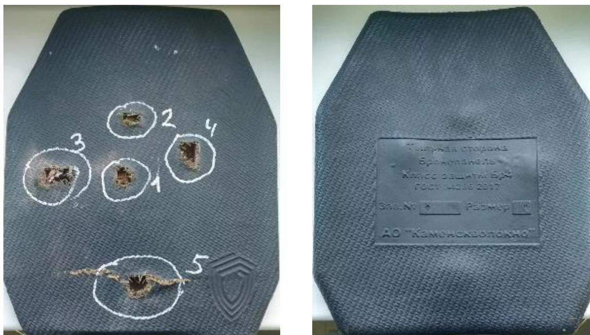
Рис.7. – Бронепанель Бр4 класса защиты после испытаний.
