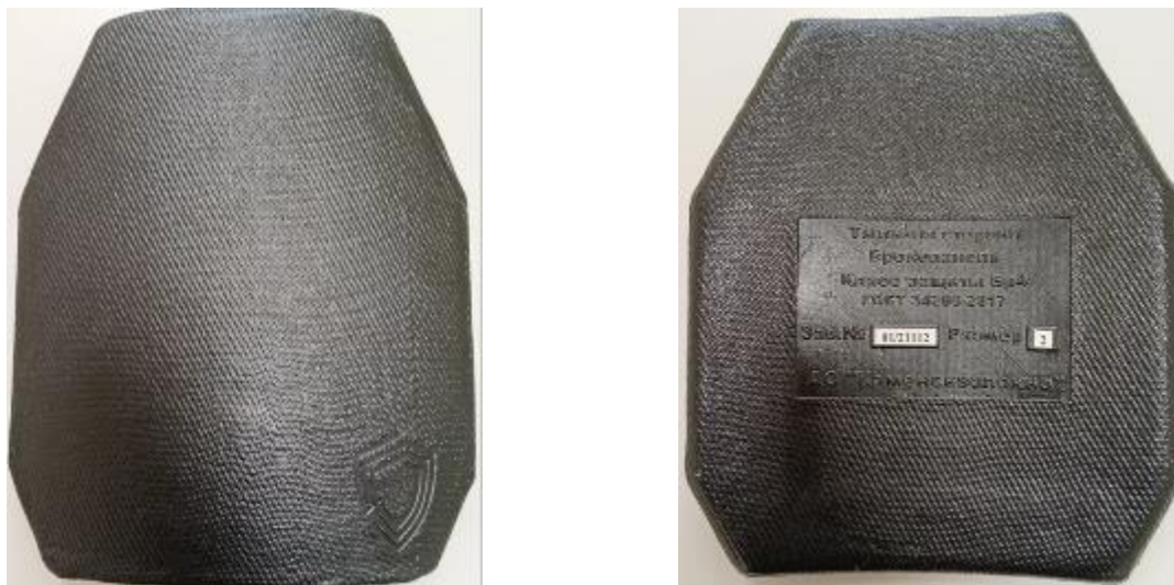
Рис. 6. - Опытный образец бронепанели Бр4 класса защиты, изготовленный на основе алюмооксидной керамики и арамидной ткани
