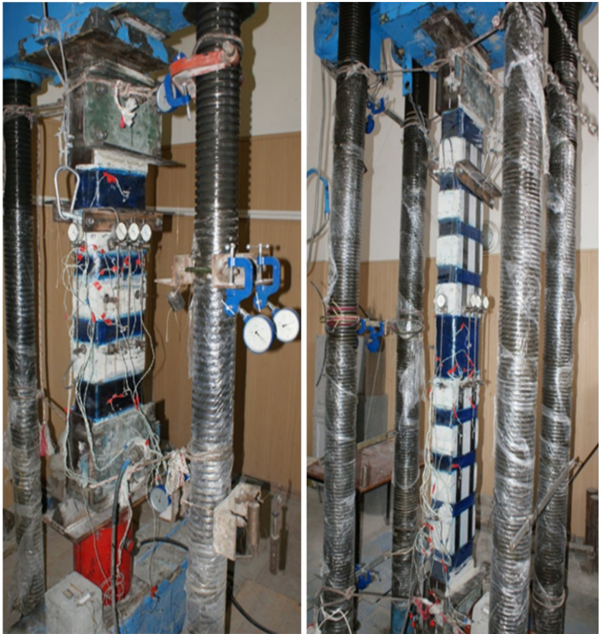
Рис 5. – Конструкция стендов для испытания коротких и длинных стоек с различными вариантами усиления и расположением механических приборов и тензодатчиков сопротивления.
