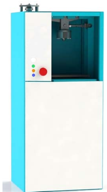
Рис. 4 Общий вид прибора динамических испытаний (ПДИ)
