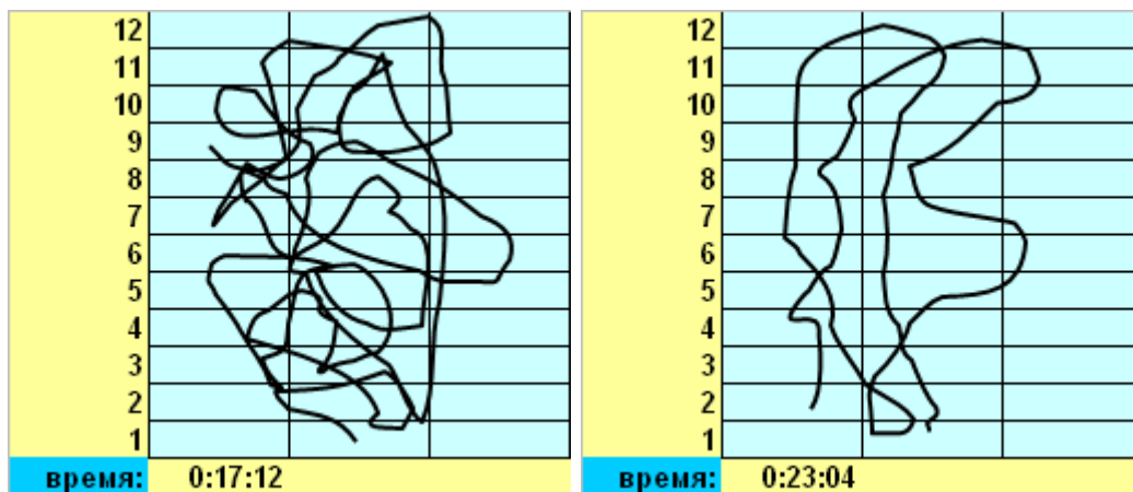
Рис. 1. Характерные траектории отдельной частицы инерта в лабораторной сушилке (скриншот программы видеофиксации)
