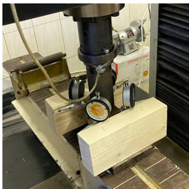
Рис. 1 - Общий вид образца в испытательной машине
