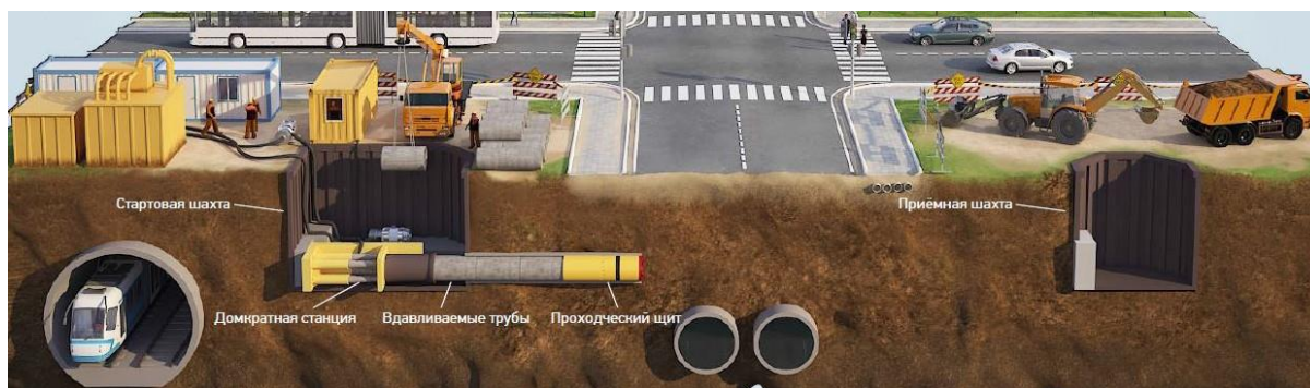
Рис. 2. – Выполнение работ методом микротоннелирования [11]
