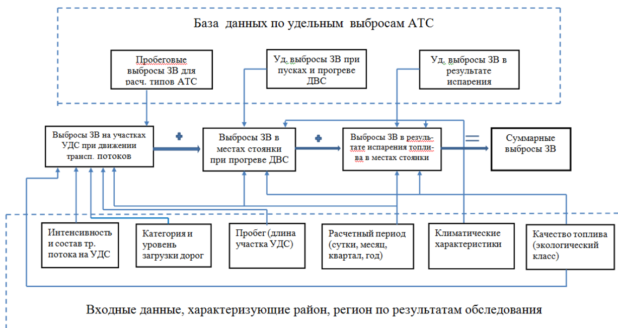
Рис. 2. - Структура расчета выбросов загрязняющих веществ автомобильным транспортом по методикам ЕЕА/COPERT и НИИАТ
