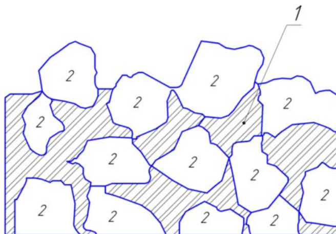
1 – керамическая связка; 2 – абразивное зерно
