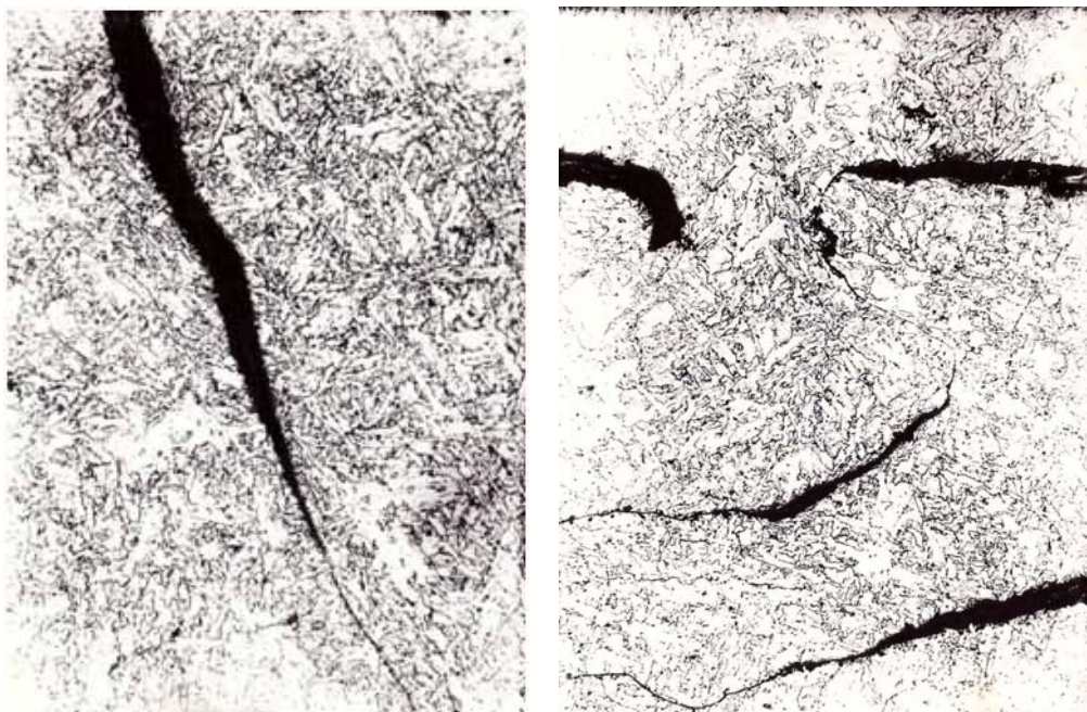
Рис.5. Межзеренные разрушения металла сварного шва у дна надреза, выявленные после термической обработки при T=923K с E=0,2\% , \times 100
