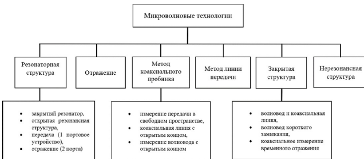
Рис. 1. - Классификация методов измерения диэлектрической проницаемости
