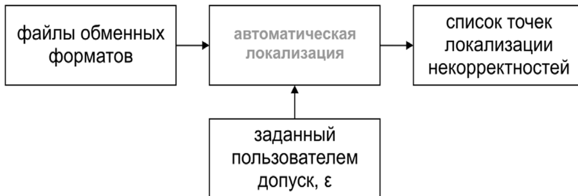
Рис. 3. – Блок-схема программной локализации некорректностей
