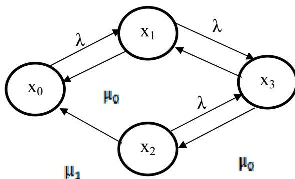
Рис. 1 - Вероятность отказа данной подсистемы при включении запасного канала  $A_2$ .
