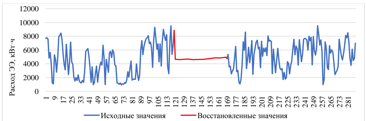
Рисунок 4. – График электропотребления с заполнением пропусков методом итеративного прогнозирования при помощи одиночных моделей
