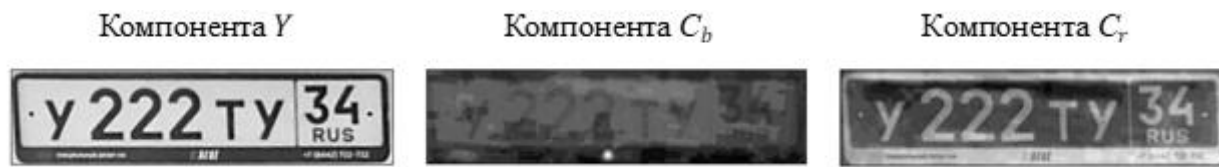
Рис. 4. – Пример преобразования изображения пластины номерного знака в цветовое пространство YC_bC_r .
