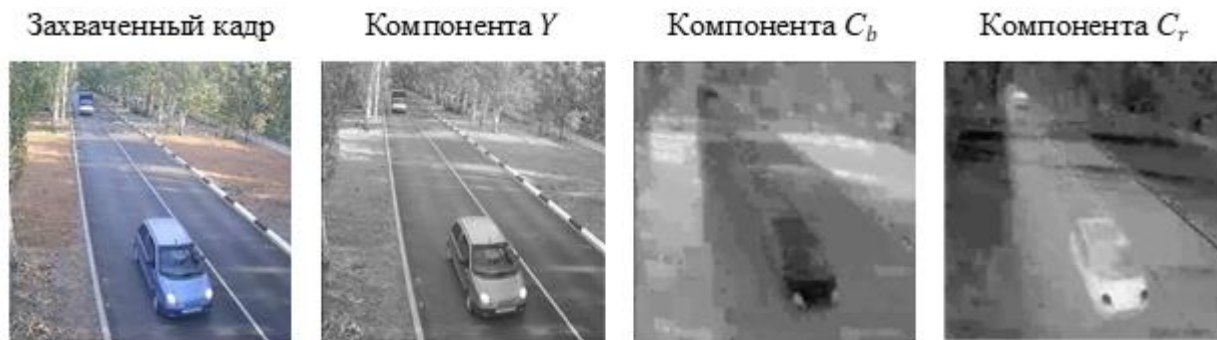
Рис. 3. – Пример преобразования захваченного кадра в цветовое пространство YC_bC_r .
