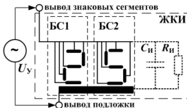
Рис. 1. – Структура ЖКИ и внутренние емкостные и резистивные связи
