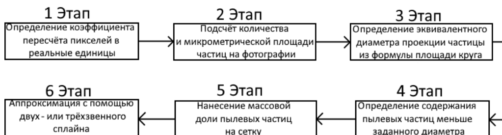
Рис. 4. – Схема проведения дисперсного анализа
