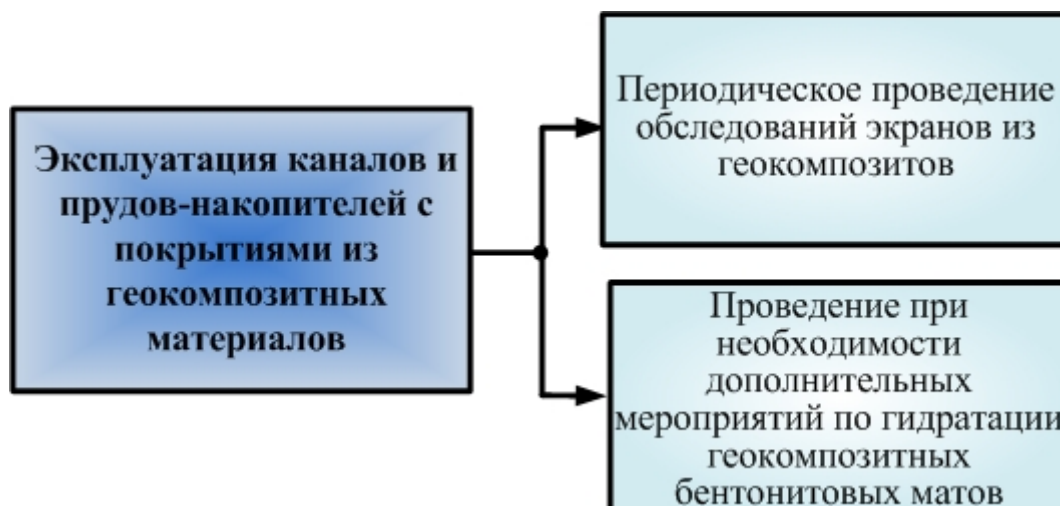
Рис. 6 – Рекомендации по эксплуатации противofильтрационных экранов из ГСМ
