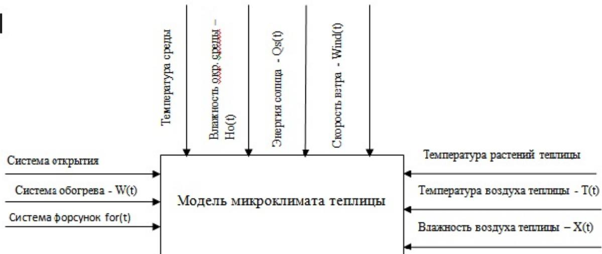
Рис. 1. - Структурная модель температурно-влажностного режима теплицы
