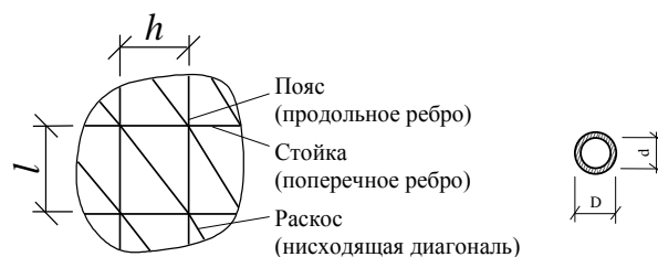
Рис. 1 – Фрагмент цилиндрического сетчатого покрытия с сечением стержней из горячекатаных бесшовных труб
