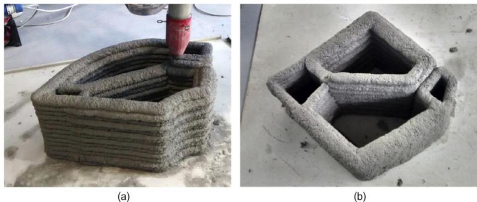
Рис. 1 - Процесс печати (a) и напечатанный элемент (b)
