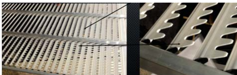
Рисунок 1. Комбинированное решето на основе полимерного материала СВМПЭ.
