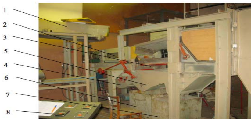
Рисунок 2. Экспериментальная установка блока очистки зерноуборочного комбайна . 1 – подающее устройство; 2 – стрясная доска; 3 – решенный стан; 4 – вентилятор; 5 – блок шнеков; 6 – бункер зерна; 7 – колосовой бункер; 8 – блок управления
